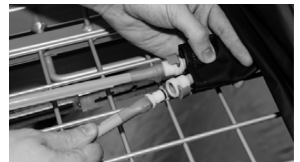
C. Utilice los conectores de acoplamiento rápido para conectar los tubos de inflado a los tubos de las membranas de aire (rojo a rojo), asegurándose de que no se enreden ni se pincen.
