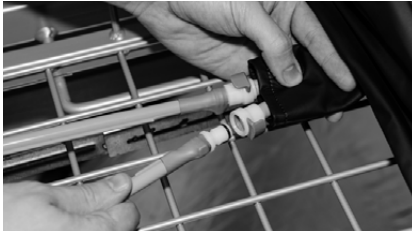
ج. باستخدام الموصلات السريعة، قم بتوصيل خراطيم نفخ الهواء بخراطيم الهواء الخلوي - "الأحمر إلى الأحمر" - للتأكد من أن الخراطيم ليست ملتوية أو متعرجة.
