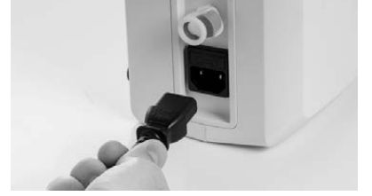
ز. قم بتوصيل وحدة التحكم بالطاقة الرئيسية عن طريق الطاقة المتوفرة.
