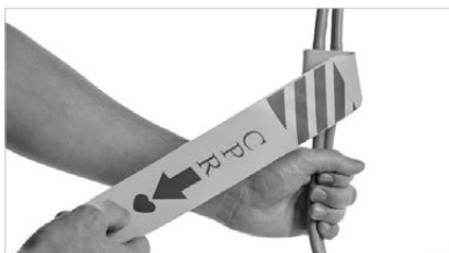
D. Controllare che le valvole di sgonfiaggio CPR siano posizionate correttamente per assicurarsi che non vi siano perdite d'aria.
